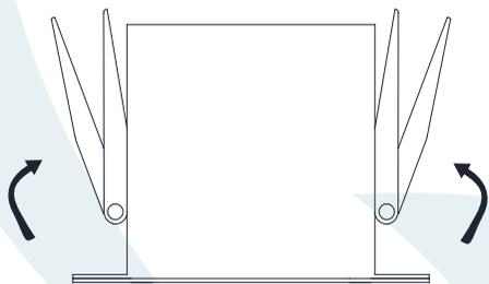
2º - Faça as instalações elétricas, e para fixar o embutido no teto pressione as molas.
