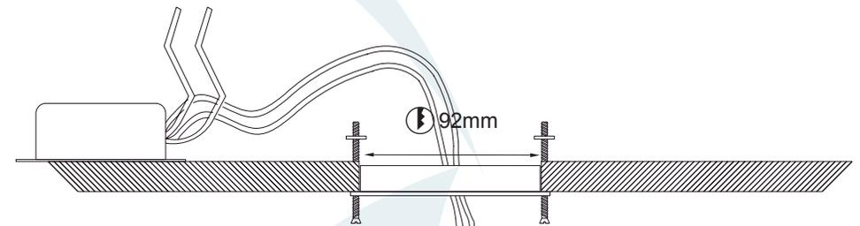
1º - Inserir o anel na abertura e fixar com os parafusos.
