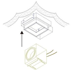
**4** Colocar o corpo central da luminária no requadro, depois colocar a lâmpada.
