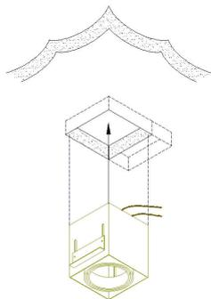
**2** Encaixar o requadro, e depois completar o furo com gesso para que o requadro fique fixo no furo.
