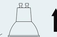
4° - Encaixar a lâmpada sem forçar o soquete e colocar o aro para fixá-la.
